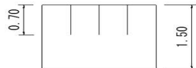
図-8 削孔配置図 (断面)
