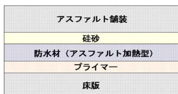
<図5 塗膜系床版防水層の層構成>
